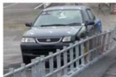
センターパイプ小型車衝突実験状況
