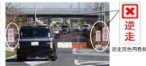
逆走警告用看板を車載カメラが読み取り、ドライバーに警告を発出
