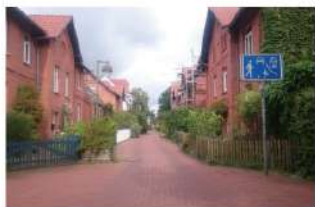
歩行者と自動車とが共存する道路空間：遊びの道 (ドイツ連邦共和国ニーダーザクセン州)
