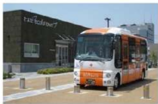
ライジングボラードによる車道の進入制限 (愛知県豊田市)
